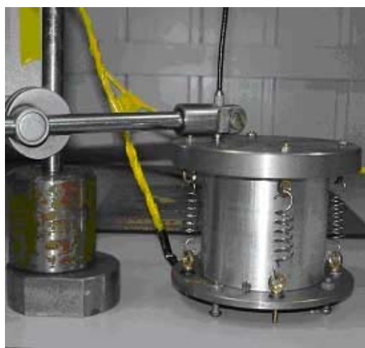
Рис. 2. Фотография МЭ-демпфера
